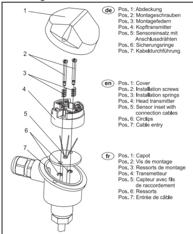
**de** Verdrahtung auf einen Blick**en** Wiring overview**fr** Raccordement
